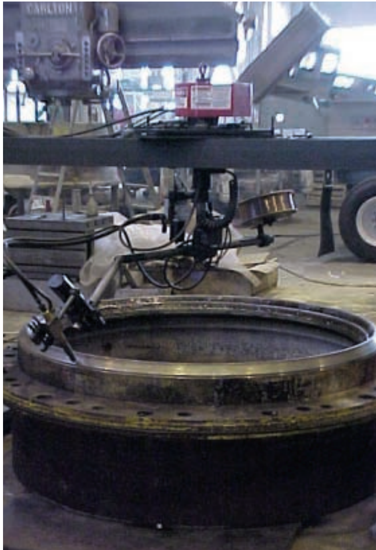
Bortech Modelo 1202 en aplicación de diámetro externo cónica
