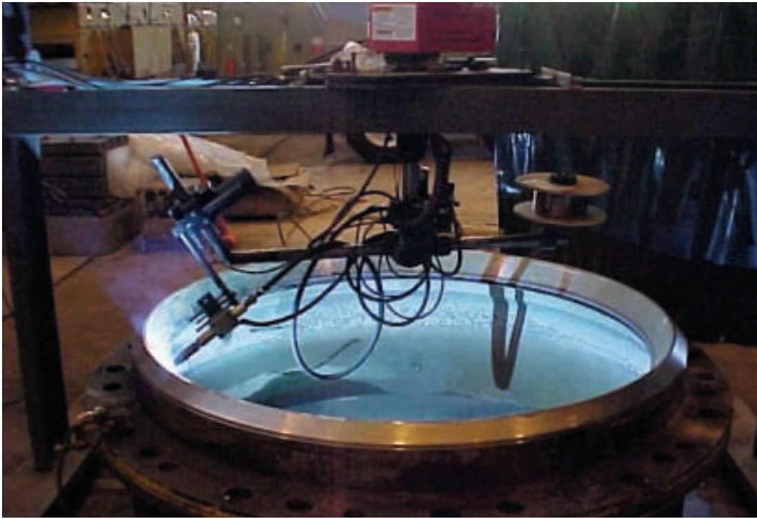
Bortech Modelo 1202 en aplicación de diámetro interno cónica
